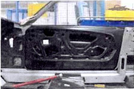
Plus que jamais, la table de mesures, sur laquelle repose la Mustang, est primordiale. Grâce à cet équipement, qui n'est malheureusement pas à la portée de toutes les bourses, il est possible d'ajuster le châssis et les pièces au millimètre près. Il faut installer la portière côté conducteur, effectuer les nombreux ajustements et fixer le panneau arrière au micron près.
